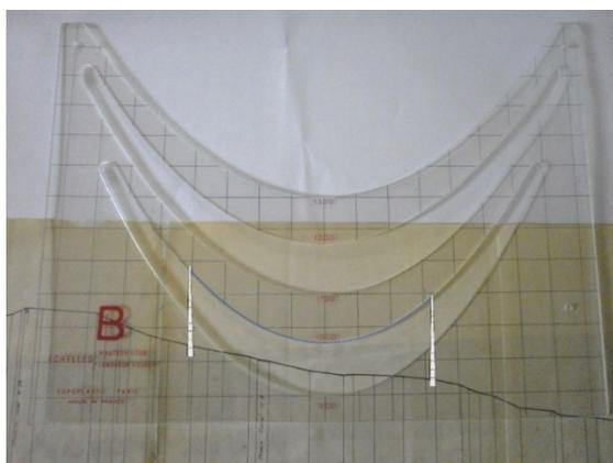
**Le premier problème à résoudre était de vérifier si les distances par rapport au sol étaient respectées à 40 °C sans vent**, selon le profil du terrain, les portées, les positions et hauteurs des supports. Le choix du paramètre se faisait en dessinant les supports et les câbles sur le plan, le projeteur avait toute la liberté de manœuvre pour choisir le paramètre optimal, en ayant un paramètre identique sur toutes les portées du canton. Il devait établir un compromis entre :
