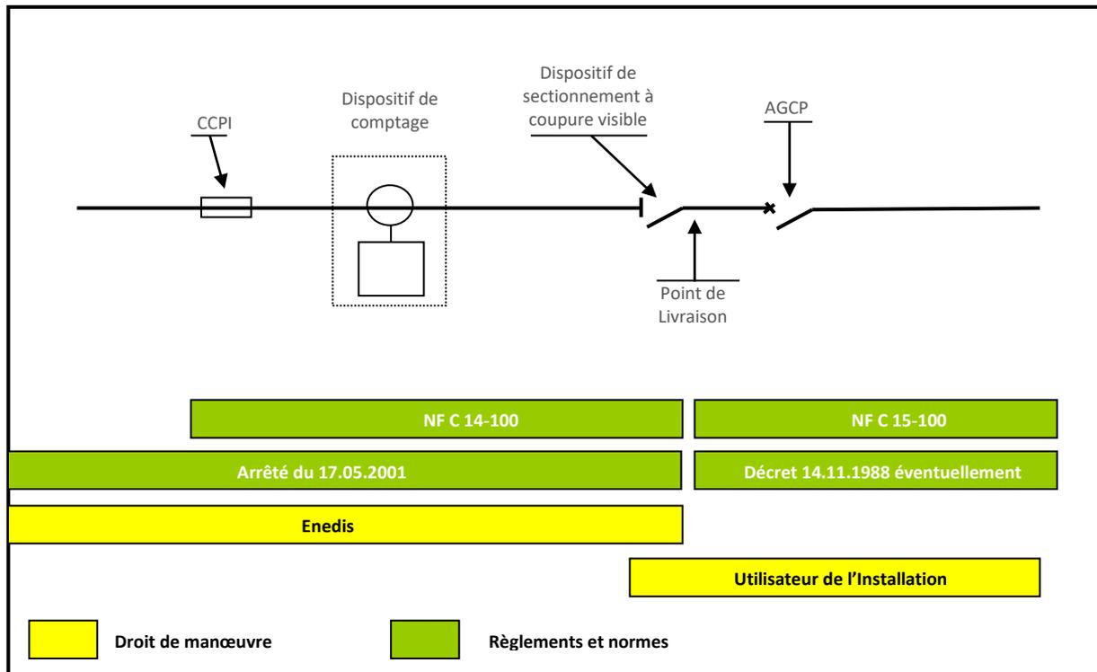
La Limite d'Exploitation entre l'Installation de Production et le Réseau Public de Distribution BT est fixée au Point de Livraison représenté sur le schéma ci-dessus.
