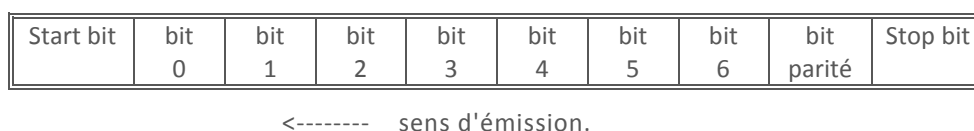
Figure 4 : Codage des bits lors de l'émission d'un caractère
