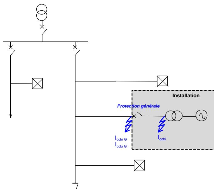
On vérifie qu'un réglage ( $I_{réglage}$ ) est possible en respectant les conditions suivantes :
