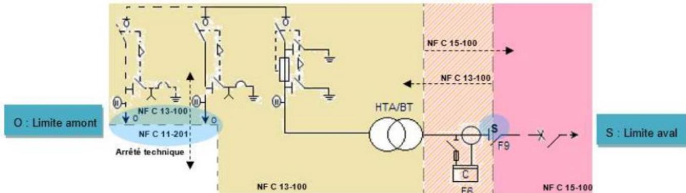
Installation  $U_n \leq 33\text{kV}$  et  $I_n \leq 630\text{A}$  : comptage HTA (NF C13-100)
