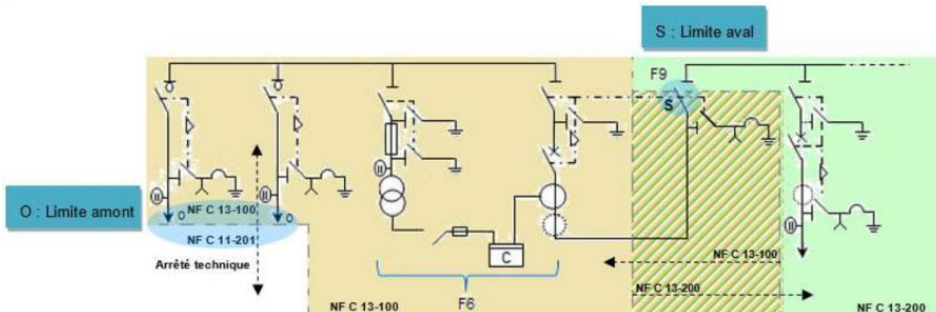
Installation Un > 33kV ou In > 630A : comptage HTA (NF C 13-200)
