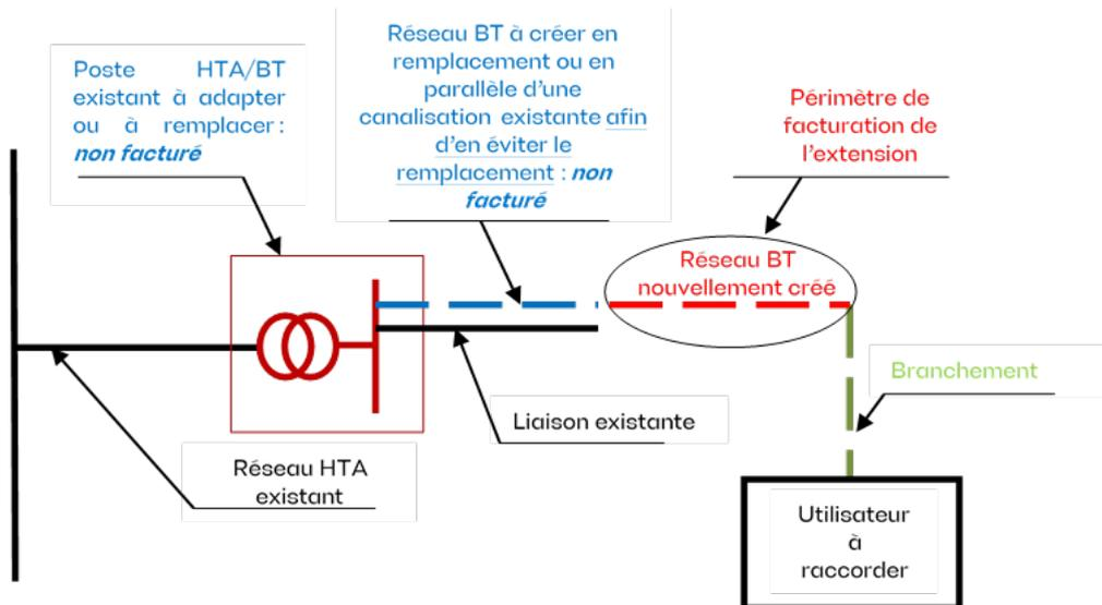
Lorsque l'opération de raccordement de référence consiste à créer un nouveau poste HTA/BT, le périmètre de facturation de l'extension comprend les frais correspondant à la création du poste HTA/BT et son alimentation HTA, ainsi que la création du départ BT permettant de raccorder l'installation.
