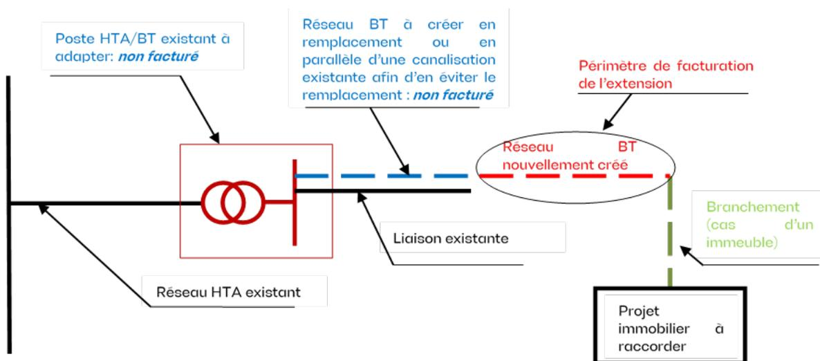
Lorsque l'opération de raccordement de référence consiste à créer un nouveau poste HTA/BT, le périmètre de facturation intègre la création d'un poste de transformation HTA/BT, la canalisation HTA nouvellement créée pour raccorder ce poste, ainsi que la création de la canalisation BT.
