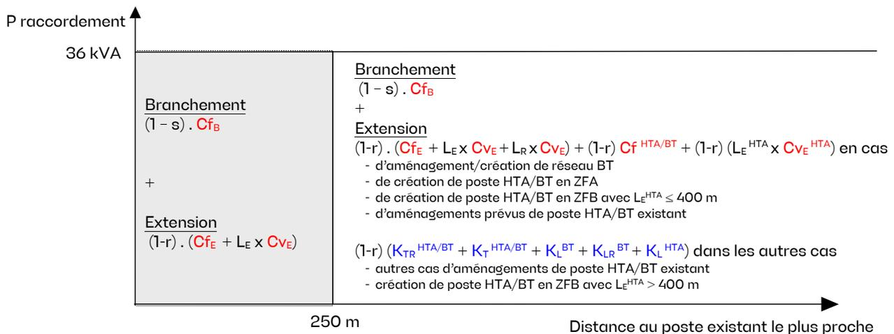
Figure 1 : composants de la facturation des branchements et des extensions en Basse Tension  $\leq 36$  kVA
