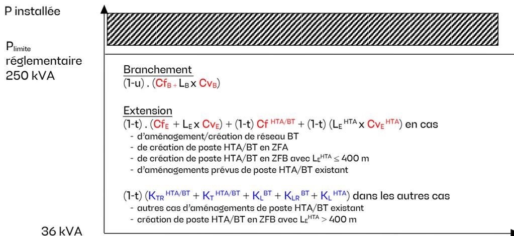
**Figure 5 : composants de la facturation des branchements et des extensions**
