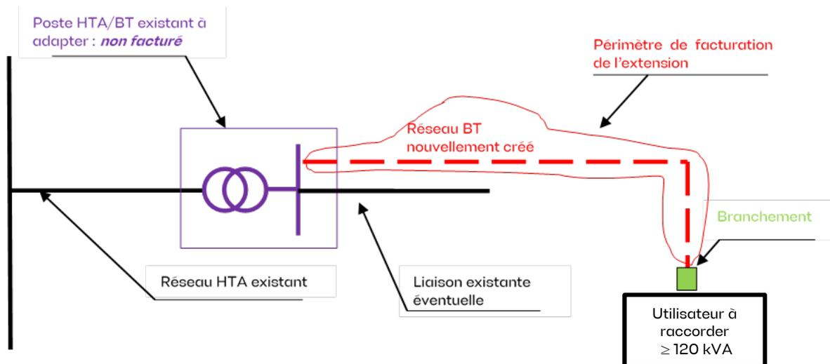
Lorsque l'opération de raccordement de référence consiste à créer un nouveau poste HTA/BT, le périmètre de facturation de l'extension comprend les frais correspondant à la création d'un poste HTA/BT et son alimentation HTA, ainsi que la création du départ BT permettant de raccorder l'installation.
