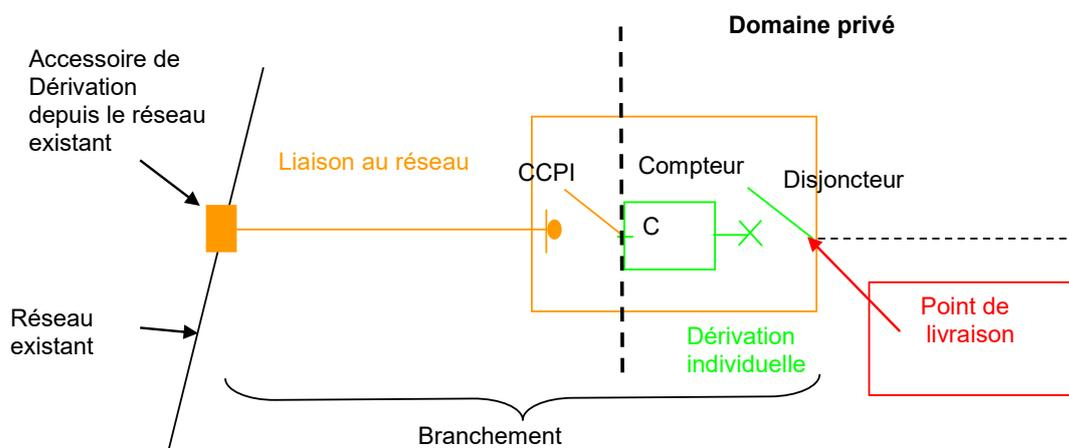
La liaison en partie privative en aval du point de livraison est entièrement réalisée par le demandeur; elle ne fait pas partie des ouvrages concédés à Enedis et doit être conforme à la norme NF C 15-100.
