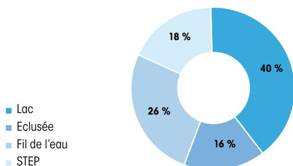
Les « centrales au fil de l'eau », situées principalement en plaine, présentent une retenue de faible hauteur et ont une capacité du réservoir amont très réduite (inférieure à 2 heures). Ces installations ont donc de faibles capacités de modulations par le stockage et leur production dépend du débit des fleuves.
